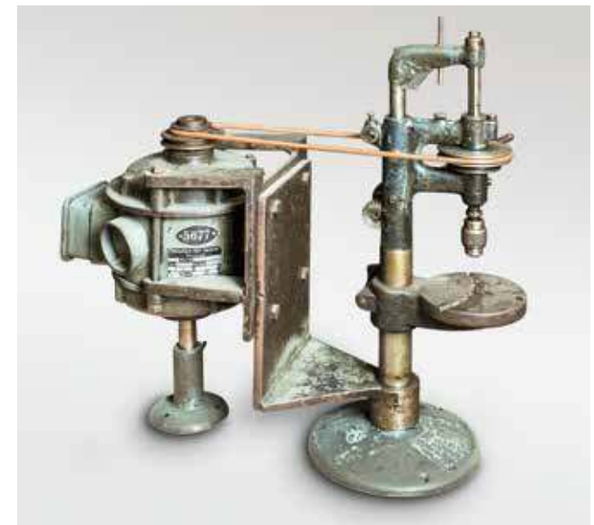
Präzisions-Schnellbohrmaschine »Größe 3«, um 1920 Uhrenmuseum Ruhla, Foto: Digitalisierungsteam, Marcus Rebhan und Stephan Tröbs, Museumsverband Thüringen e.V.
